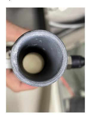
④消泡フィルターが汚れていないか確認。汚れていたら交換。
