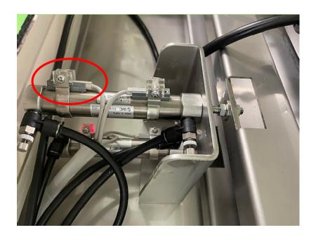
リードスイッチを固定しているビスを緩めて左右にずらしリードスイッチが点灯する位置を探す。その位置が約 10 mm弱程あるのでその真ん中で固定する。
