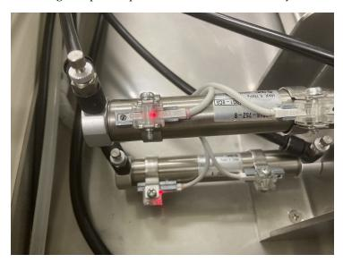
点灯しない場合は反対側の洗浄ヘッドのリードスイッチがずれているので、それを調整した後、反対側 も再度調整する。
