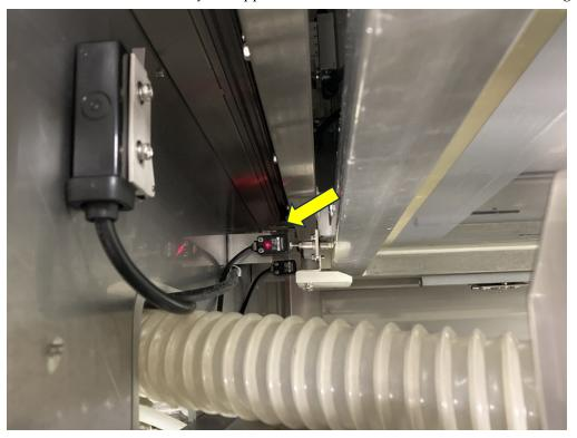
センサーにスケール等をあてがい点灯しなければセンサー故障または配線の接触不良が考えられる。点灯する場合はL版投入した時に出る下写真のボルトをセンサーが点灯する距離になるようナットをゆるめ調整する。
