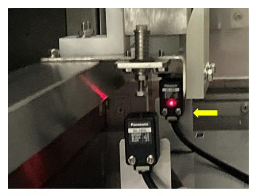
下側のセンサーにスケール等をあてがい点灯しない場合はセンサー故障または配線接触不良が考えられる。点灯する場合は M 版アダプターの先端と近接センサーのクリアランスが広いのでセンサーのビスを緩めて近づける。 If the sensor on the bottom does not light up when you place a scale on it, the sensor may be broken or the wiring may be loose. If the sensor lights up, the clearance between the tip of the M adapter and the proximity sensor is large, so loosen the screws on the sensor and move it closer.
